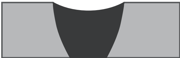
Excesso de penetração (BURN THROUGH)
