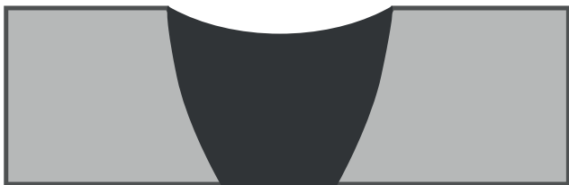
Excesso de penetração (BURN THROUGH)
