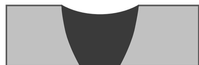
Excesso de penetração (BURN THROUGH)
