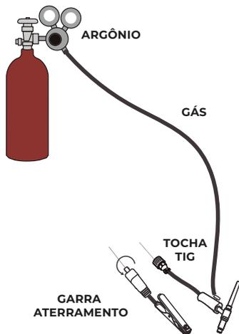
**1** - Conecte a **tocha tig** ao pólo negativo da máquina e tenha certeza de que ao girar o mesmo esteja bem fixado. Evite o mau contato.
