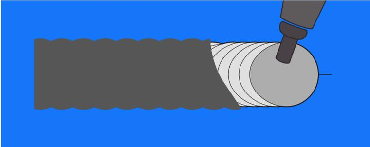
A **escória** protege a solda contra as impurezas. Após a solda finalizada, é aconselhado que se retire a escória com uma picadeira de solda.
