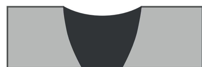
Excesso de penetração (BURN THROUGH)
