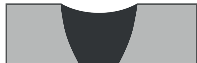
Excesso de penetração (BURN THROUGH)
